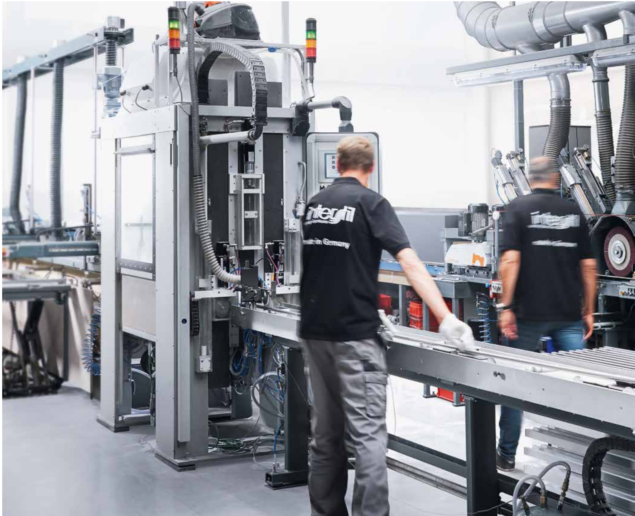
Anlage zur Beschichtung der Laufkanäle. Eine Entwicklung aus unserem Sondermaschinenbau.
